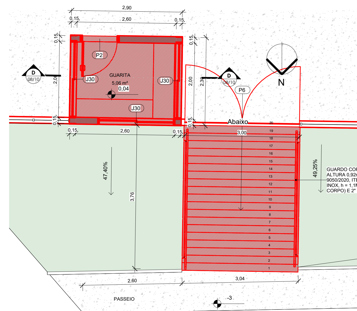
CONST. 1º PAVIMENTO - PLANTA BAIXA GUARITA 1 : 50
